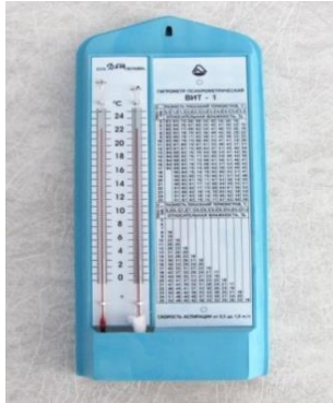
Рисунок 3 – Статичний психрометр Августа
