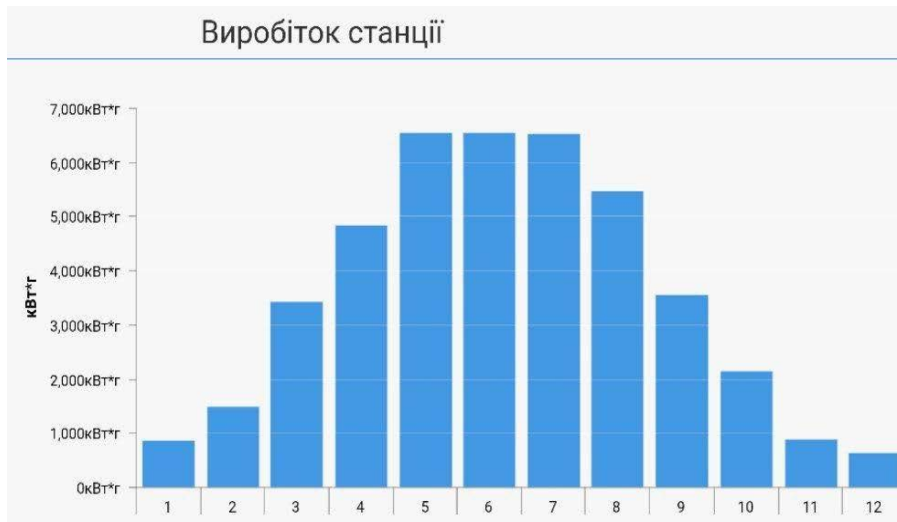
Рисунок. Графік виробництва електроенергії з використанням 100 полікристалічних сонячних панелей на території Харківської області
