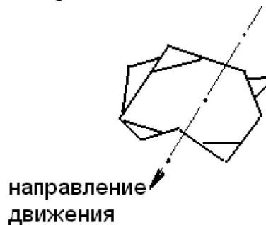
Рис. 3 – Схема беспорядочного расположения выступов зерна
