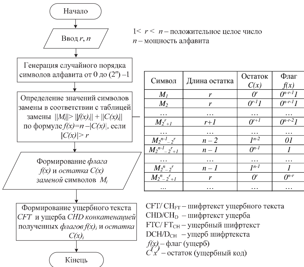
Рис. 5. Универсальный механизм нанесения ущерба (алгоритм MV2)
