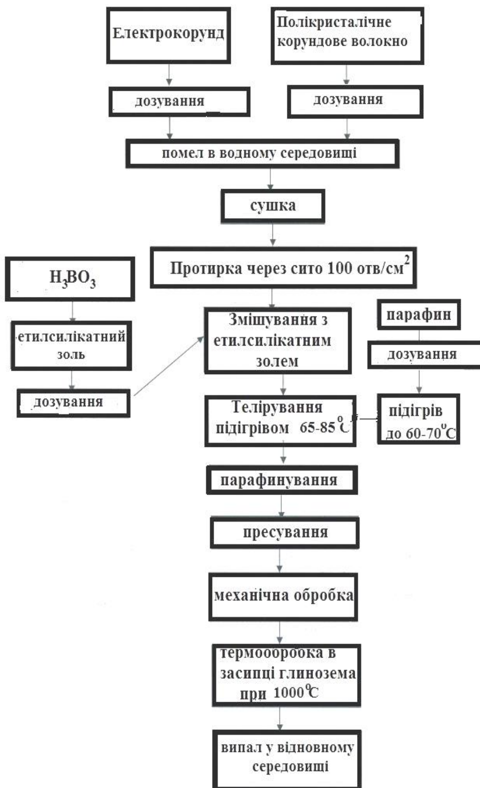
Рисунок 13. – Технологічна схема виробництва КМ з використанням полікристалічного корундового волокна
