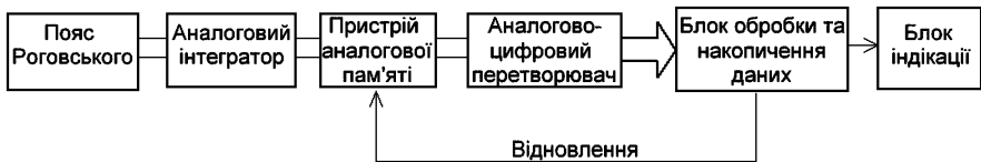
Рисунок 1 – Блок-схема системи вимірювання параметрів імпульсів струму
