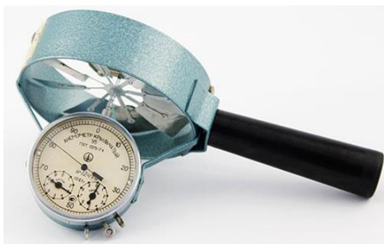
Рисунок 9 – Анемометр ручний крильчастий з лічильником АСО-3
