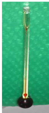
Рисунок 7 – Зовнішній вигляд кататермометра з кульовим резервуаром
