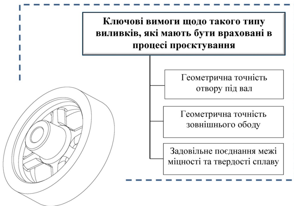
Рисунок 2.6 - Представник виливків типу «шків» та ключові показники, по яких оцінюється ефективність проєктування
