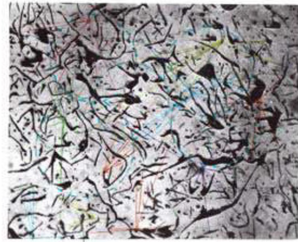
Рисунок 4.15 - Мікроструктура чавуну, модифікованого феросиліцієм ФС75, x150
