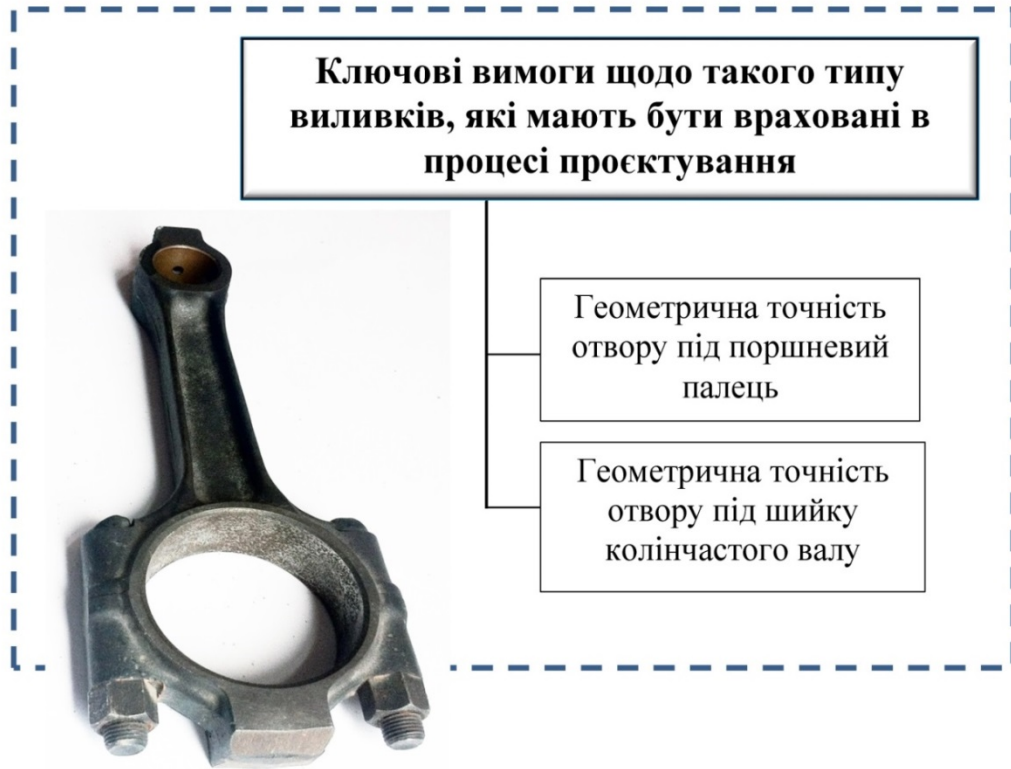
Рисунок 2.5 - Представник виливків «шатун» та ключові показники, по яких оцінюється ефективність проєктування
