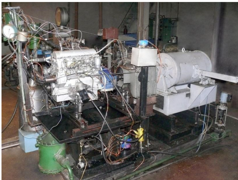
Рисунок 4.2 - Стенд для дослідницьких та приймально-здавальних випробувань дизелів серії ДТНА
