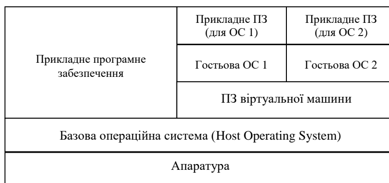
Рисунок 1.1 – Схема роботи віртуальних машин
