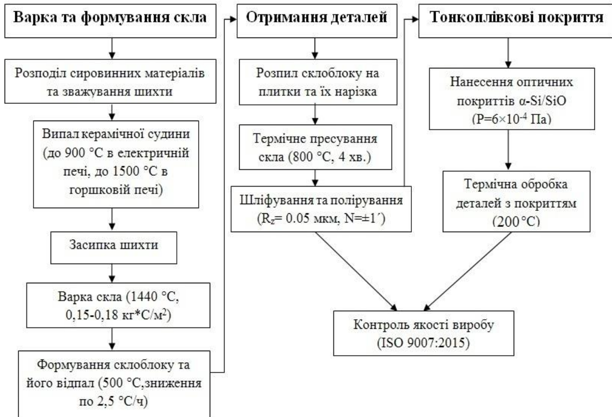
Рисунок 11 – Послідовність технологічних операцій одержання деталей з розробленого оптичного скла ІЧС-611
