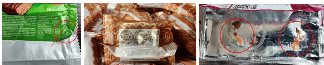
а – монополімерне пакування вафель з маркуванням виду полімерного матеріалу; б – пакування цукерок без маркування; в – жирове забруднення пакування
