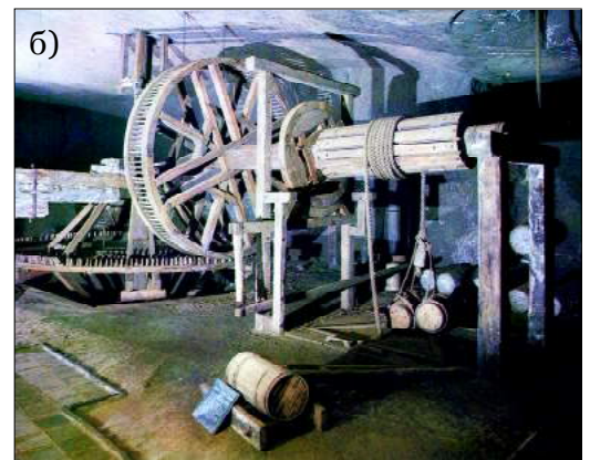
Рис. 4.111 - Конструкції кінних підйомників на копальні солі Величка: а - гравюра Я. Борляха, 1719 р.; б - оригінальна підймальна машина в соляній камері
