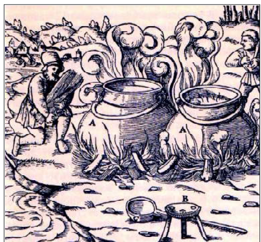
Рис. 4.174 - Випарювання соляного розчину: А - котли, В - триножник, С - черпак (за Г. Агріколою)
