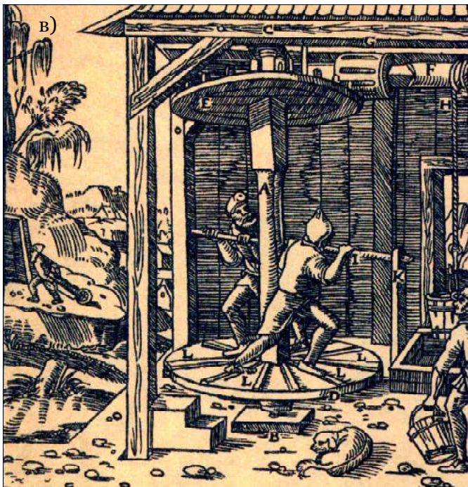
Рис. 4.109 - Підймальні машини, рух яких забезпечували гірники (за Г. Агріколою): а - звичайний коловорот; б - коловорот з маховим колесом; в - вертикальний привод із ступінчастим колесом
