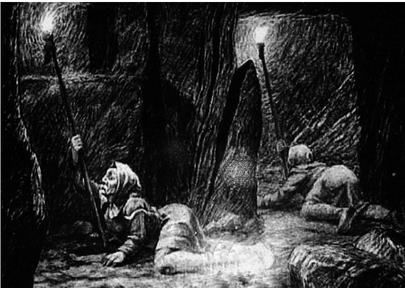
Рис. 4.96 - Випалювання метану в покрівлі виробки.
