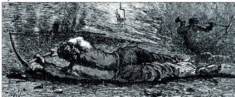
Рис. 4.150 - Гірничі роботи на мансфельдських рудниках; а - формування врубової порожнини; б - схема суцільного діагонального виймання міденосного пласта
