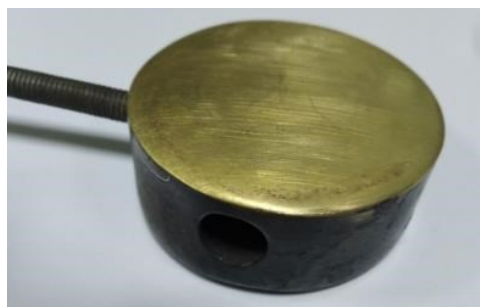
Рисунок 2.4 – Латунний диск для визначення температурних інтервалів топлення
