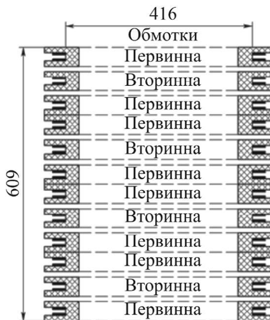
Рисунок 4.3 – Чергування модулів подвійних галет первинної і вторинної обмоток (КРУ, П.Корея)
