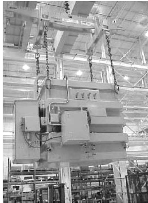
Рисунок 4.1 – Трифазний ВТНП трансформатор потужністю 5/10 МВА на заводі компанії WES [158, 159]
