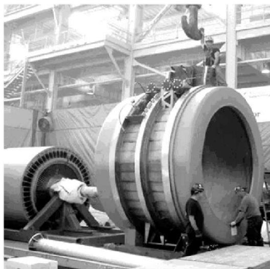
Рисунок 3.24 – Компоненти судового ВТНП двигуна AMSC потужністю 36,5 МВт на випробувальному стенді заводу Northrop Grumman
