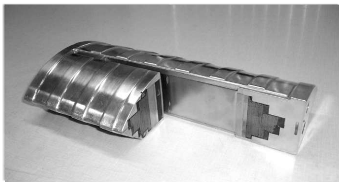
Рисунок 3.36 – Фрагмент 4-полярного ротора з діборидмагнієвого проводу (для генератора) виробництва Hyper Tech
