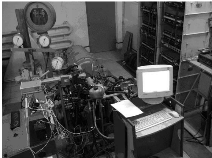
Рис. 1 – Экспериментальный стенд для исследования автомобильного биогазового ДВС
