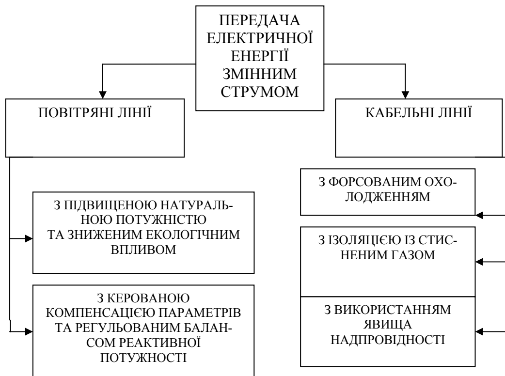
Рисунок 1 – Інноваційні рішення передачі електроенергії змінним струмом
