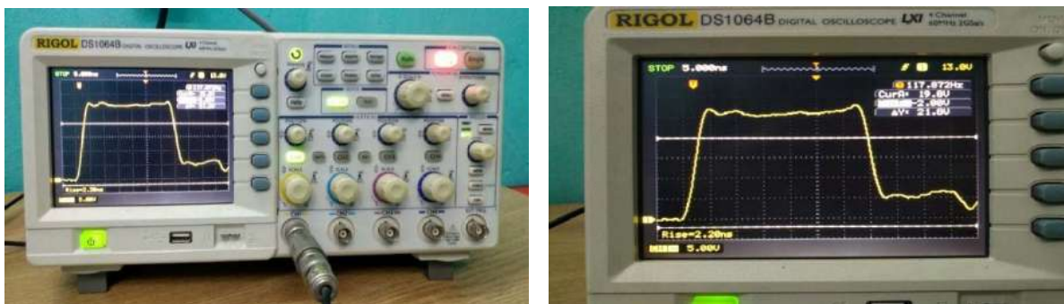
Рисунок 3 – Приклад одиночного імпульсу генератора наносекундних імпульсів з модернізованим блоком керування
