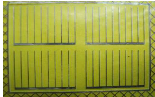
Рисунок 1 – Схематичне зображення перерізу (а) та зовнішній вигляд (б) запропонованого тонкоплівкового ємнісного перетворювача: 1 – алюмінієві струмопровідні доріжки; 2 – шар ITO завтовшки 0,2-0,3 мкм; 3 – поліімідна плівка завтовшки 15 мкм; 4 – шар \text{Al}_2\text{O}_3 завтовшки 1 мкм
