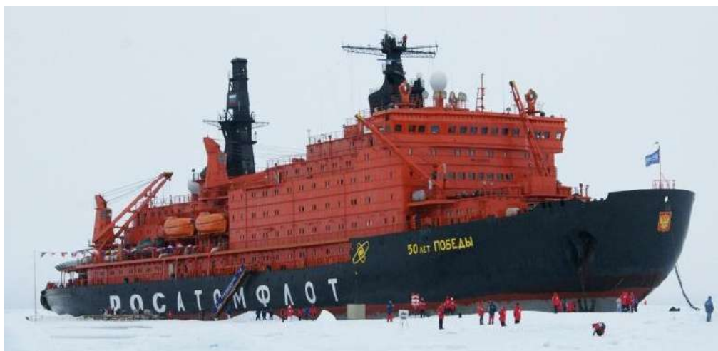
Рис. 16.6. Найбільший в світі атомний криголам «50 років Перемоги», Росія, 2007 р. Водотоннажність 25 840 т, оснащений двома ядерними реакторами, потужність двох головних турбін 75 000 к. с. (55 МВт)
