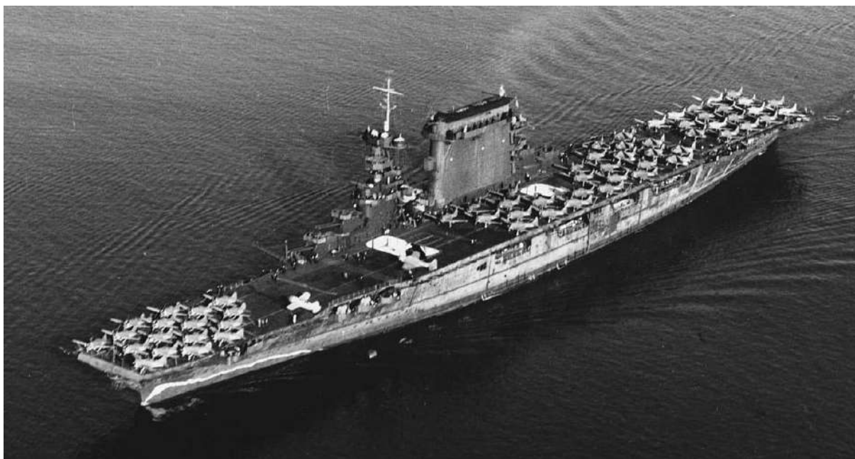
Рис. 12.7. Авіаносець «Лексінгтон», США, 1927 рік. Довжина 270,6 м, ширина 32 м, осадка 7,5 м, водотоннажність 33 000 т, бронювання: борт 178 мм, палуба – 76 мм; озброєння: 8 203-мм гармат і 12 127-мм, 78 літаків. Силова установка турбоелектрична, чотирьохвальна, потужністю 180 000 к. с.; швидкість 33 вузла, дальність плавання 12 000 миль, при швидкості 14 вузлів
