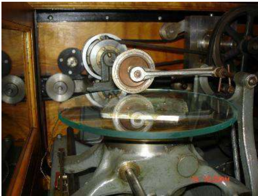
Рис. 7.17. Колісно-дисковий інтегратор є основою диференціального аналізатора Буша
