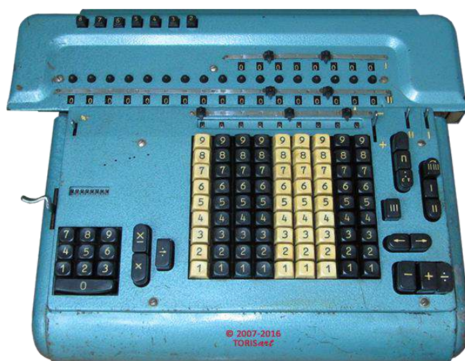
Рис. 7.9. Обчислювальна багатоклавішна напівавтоматична машина з електроприводом «ВМП-2»
