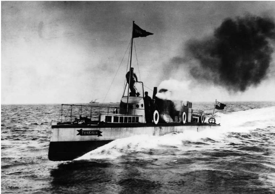
Рис. 11.18. Експериментальне судно «Турбінія». Водотоннажність 44,5 т, довжина близько 32 м
