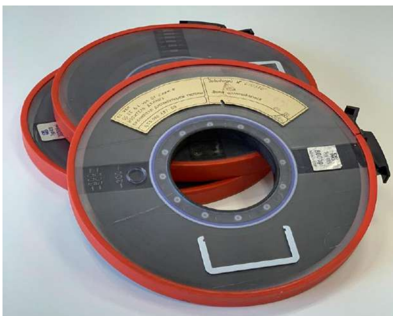
Рис. 14.9. Магнітні стрічки з операційною системою для серії радянських комп'ютерів ЕС ЕОМ
