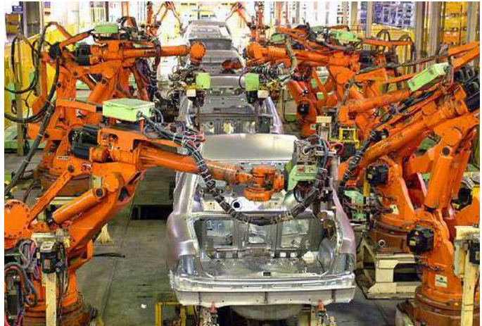
Рис. 16.2. Роботизована лінія для складання кузовів автомобілів
