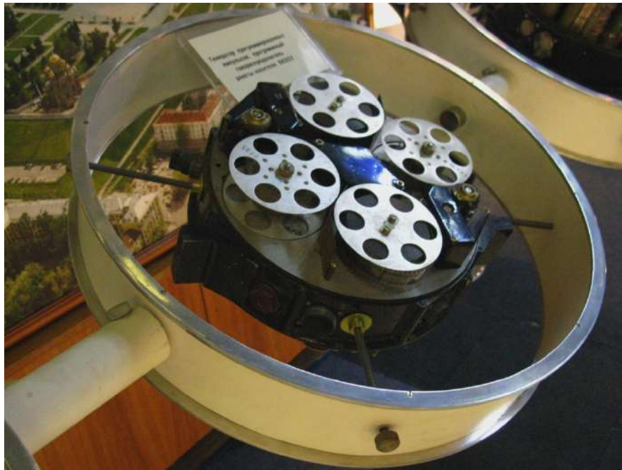
Рис. 14.5. Генератор програмованих імпульсів – програмний струмо-розподільник балістичної ракети середньої дальності Р-14У (8К65У), який використовує фотоплівку. Прилад оснащений двома бобінами фотоплівки, що дозволяє ставити виконання двох бойових польотних завдань
