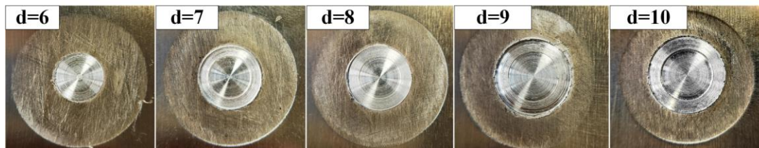
Рисунок 2.9 – Типові макроморфології при різних діаметрах інструменту
