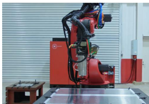
Рисунок 1.5 – Застосування ТЗТЗП в радіаторі з водяним охолодженням
