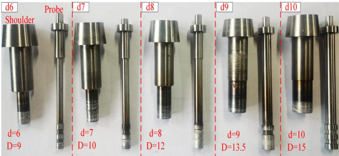
Рисунок 2.4 – Інструменти для точкового зварювання різних діаметрів
