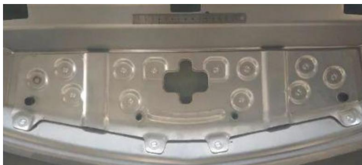
Рисунок 1.4 – Застосування ТЗТЗП на капоті автомобіля
