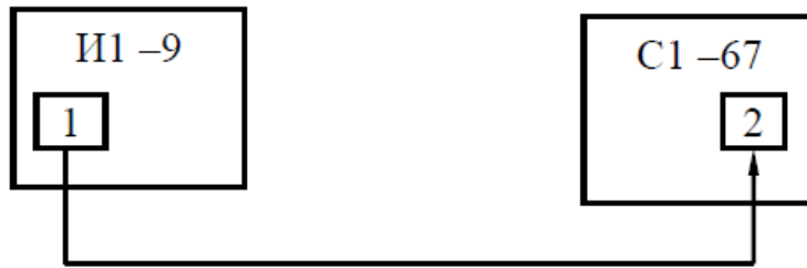
Рисунок 5.3 – Схема калібрування каналу вертикального відхилення осцилографа:
