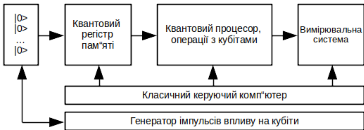
Рис. 3.23. Архітектура квантового комп'ютера
