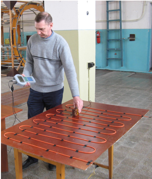
Рисунок 5.7 – Вимірювання розподілу індукції МП лабораторного макету СКЕ з коаксіальним НК типу «VOLTERM» на магнітовимірювальному стенді ІЕМС НАН України
