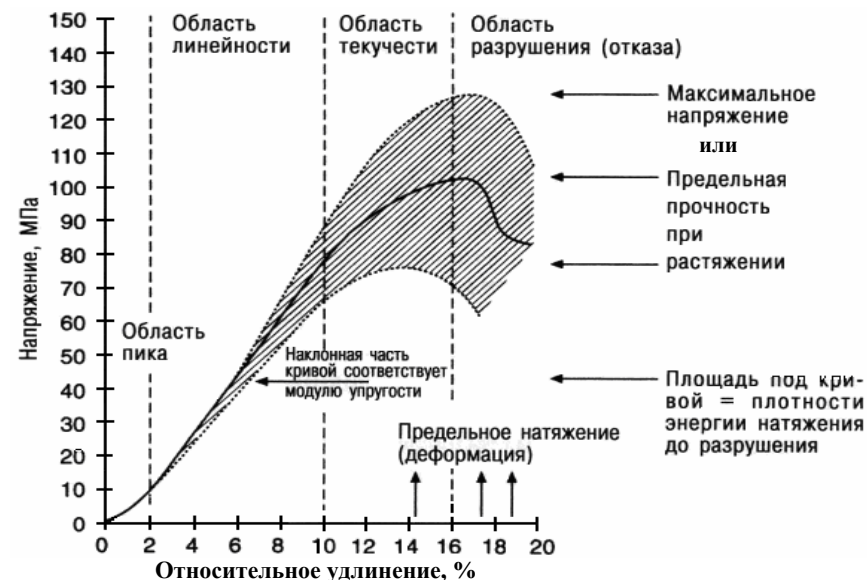
Рисунок 29 – Типичные графики зависимости напряжения от относительного удлинения для сухожилий и связок
