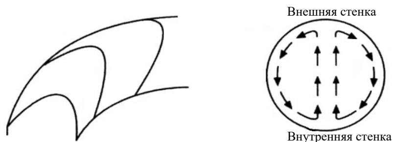
Рисунок 41 – Схема потока на изгибе в трубке
