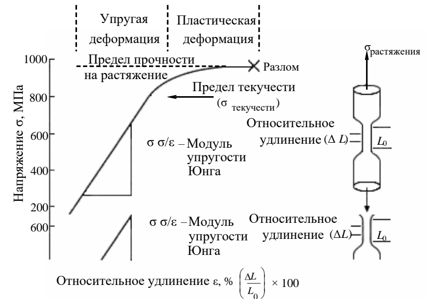
Рисунок 1 – График зависимости напряжения от относительного удлинения ортопедического сплава титана при испытании на растяжение
