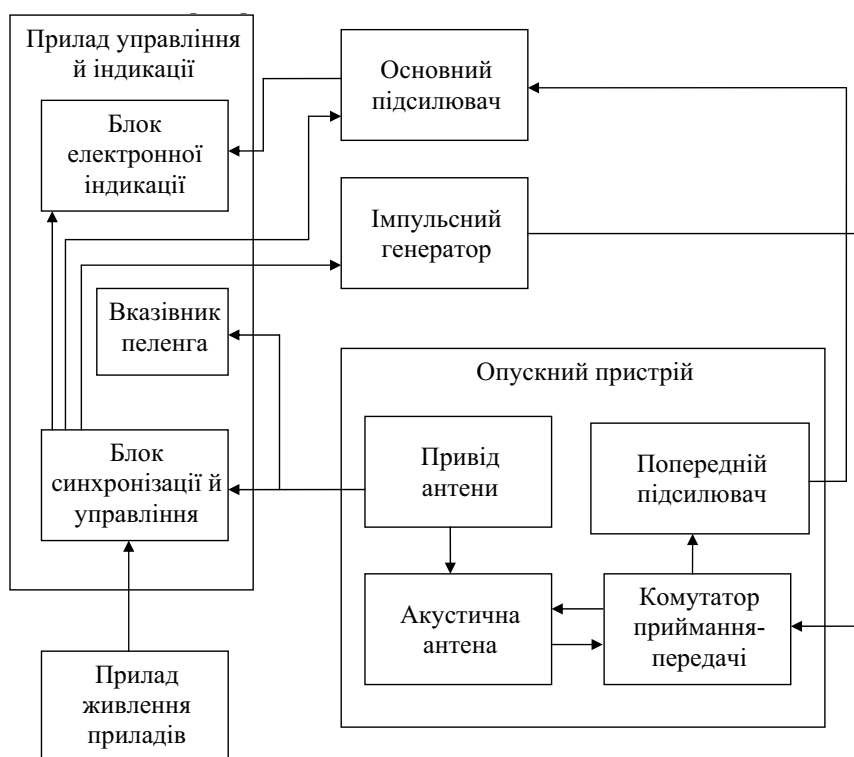
Рис. 3. Схема електричних з'єднань гідроакустичною станцією з антеною, що опускається
