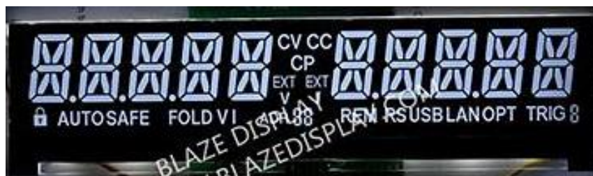
Рисунок 4.12 - Індикатор VATN фірми Blaze Display Technology (Китай) [25]
