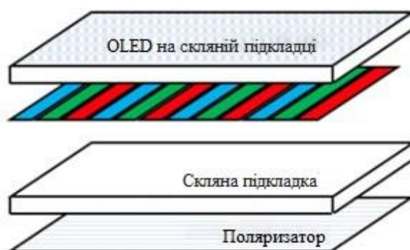
Рисунок 3.20 - Елементи конструкції дисплея OLED [16]
