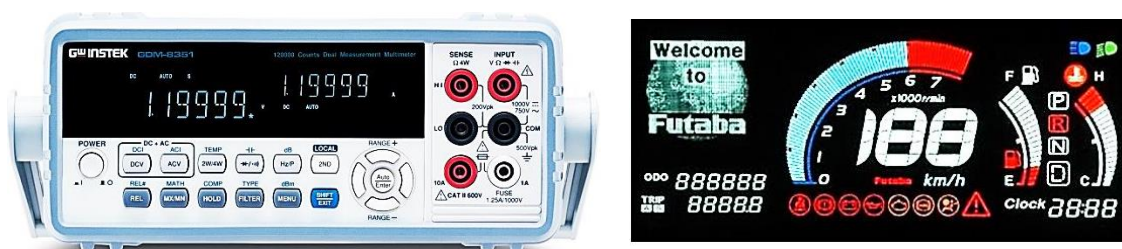
а б Рисунок 2.12 - Прилади з VFD [8, 6]
