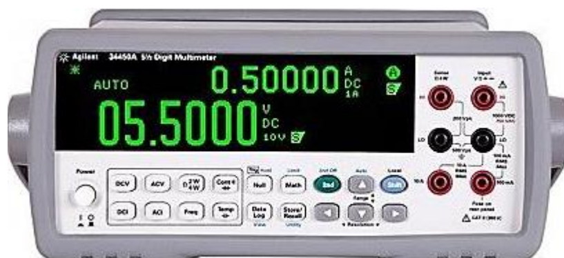
Рисунок 3.25 - Сегментні OLED в мультиметрі Keysight 34450A (США) [19]
