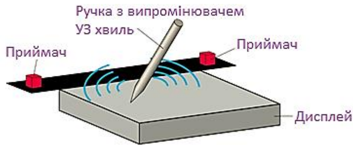
Рисунок 6.18 - Конструкція сенсорного екрану з УЗ пером
