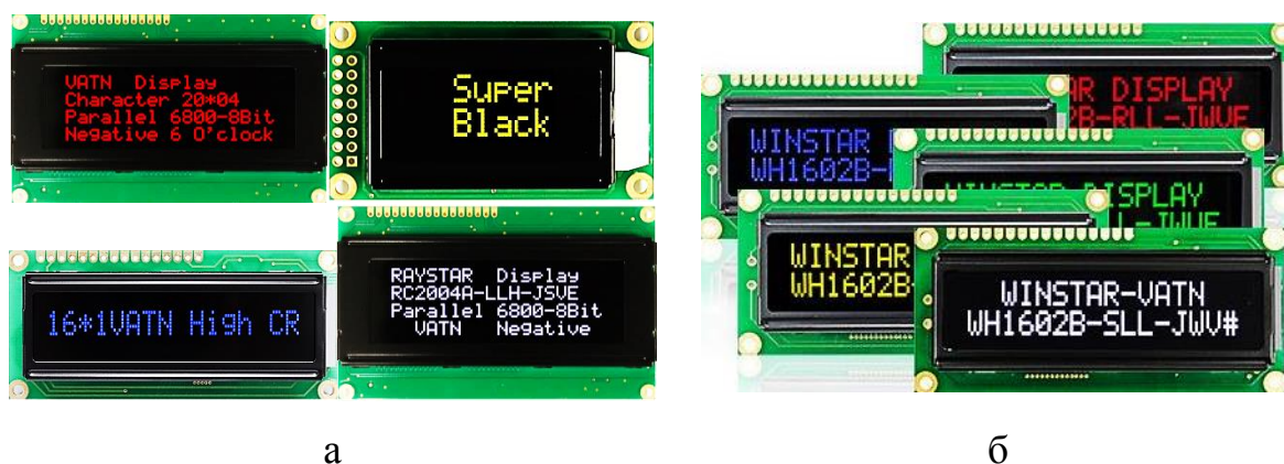
Рисунок 4.22 - LCD VATN компаній Raystar (а) і Winstar (б) [36, 37]
