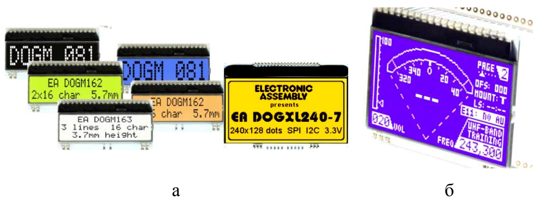
Рисунок 4.21- Символьні монохромні LCD серії DOG Display Vision [34]
