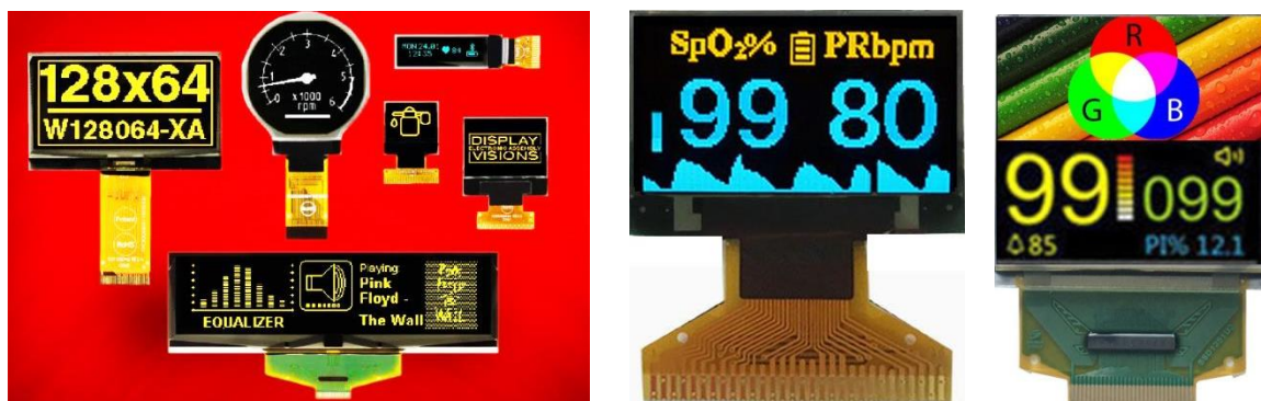
Рисунок 3.24 - Модулі графічних OLED дисплеїв [17, 18]
