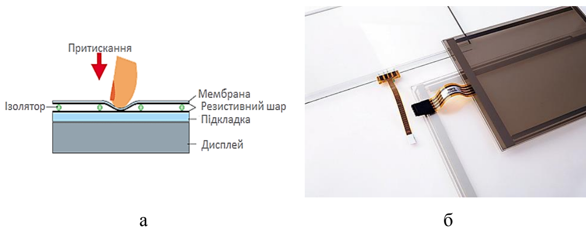
Рисунок 6.5 - Принцип дії (а) і сенсорні резистивні панелі АМТ з 4, 5 та 8 електродами (б) [43]
