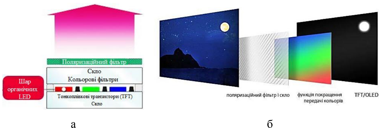
Рисунок 3.26 - Структура (а) і панельна (б) конструкція OLED екрану
