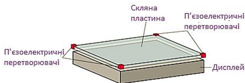
Рисунок 6.17 - Конструкція сенсорного екрану на основі технології APR
