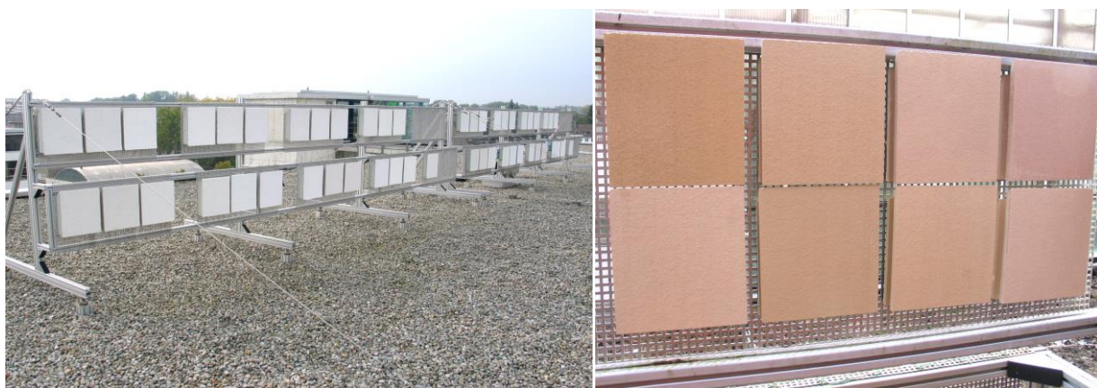
Рис. 2. – Проверка биоустойчивости образцов материалов на полевом стенде
