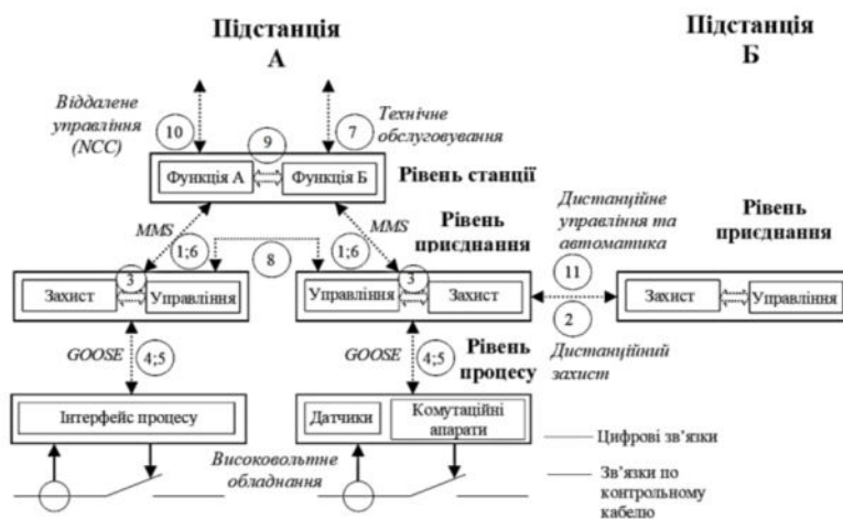
Рисунок 1 – Структура та принципи взаємодії цифрових підстанцій
