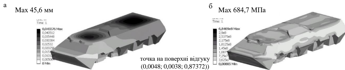
Рис. 15. Характеристики НДС з параметрами, обґрунтованими з використанням програмного комплексу ANSYS: а – переміщення; б – напруження за Мізесом
