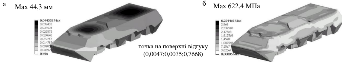
Рис. 14. Характеристики НДС з параметрами, обґрунтованими з використанням розробленого підходу: а – переміщення; б – напруження за Мізесом
