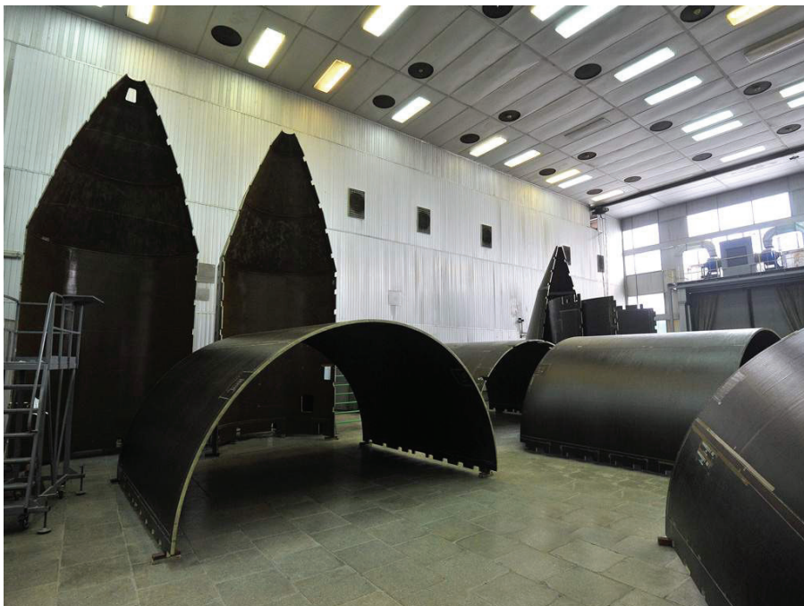
Рисунок 1 – Вуглепластикові елементи корпусу космічного апарату
