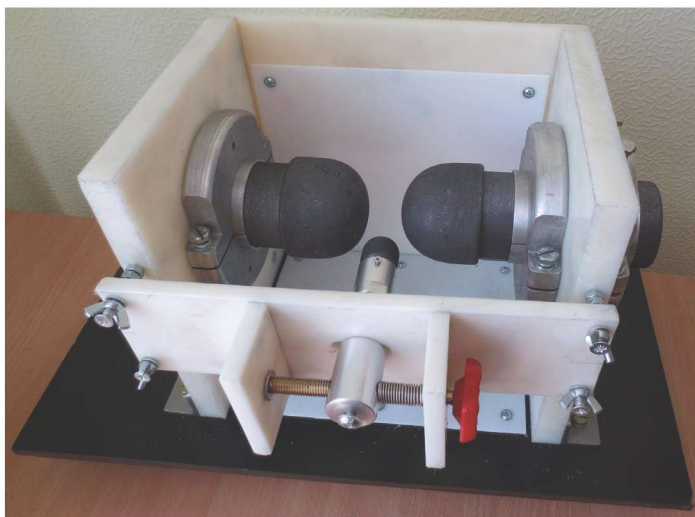
Рисунок 1 – Общий вид высоковольтного управляемого разрядника с графитовыми электродами РВГУ-50
