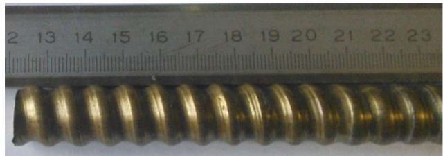
Рис. 12 – Латунна труба D=16 мм з товщиною стінки s=1 мм, отримана шляхом накатування без оправки та протитиску
