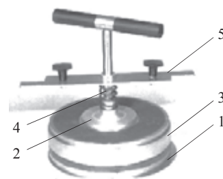
Рис. 6. Електромагнітний привід з пристроєм фіксації Fig. 6. Electromagnetic drive with locking device
