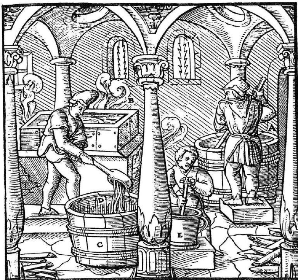
Діжка (A), в якій соду змішують із сечею. Черен B для виварювання соди. Діжка (C), в якій загущують хризоколу. Дріт D. Ступка E.
