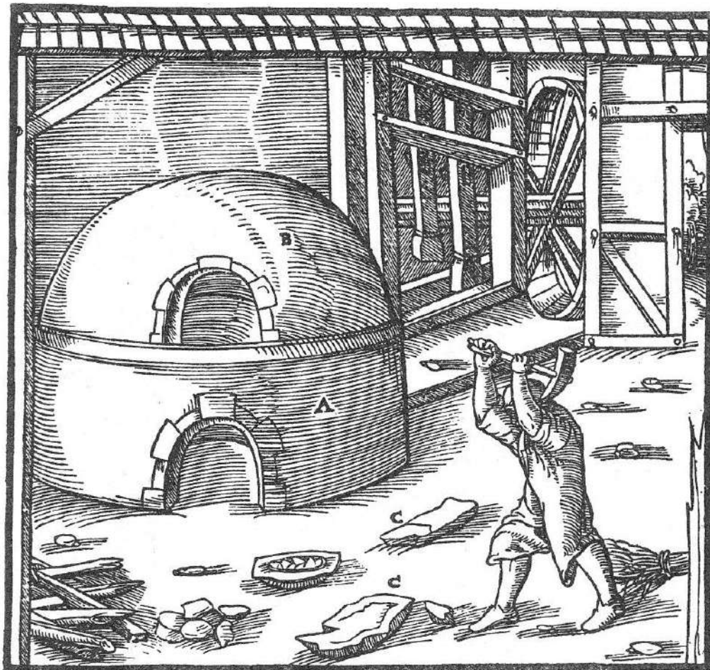
Нижня камера першої печі А. Верхня камера В. Скліяна маса С.
