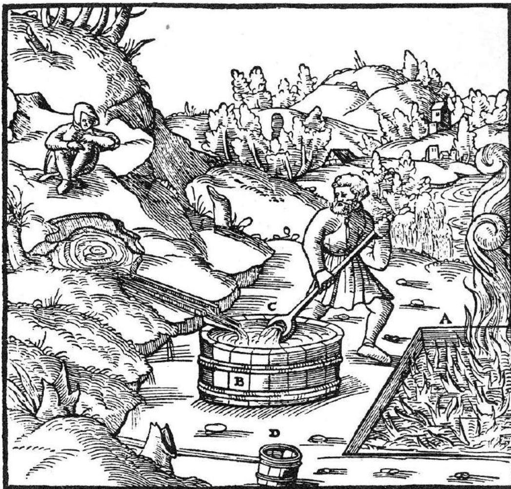
Яма A . Чан ( B ), в який спрямовують розсіл. Ківш C . Черпак ( D ) з вправленою в нього рукояттю.
