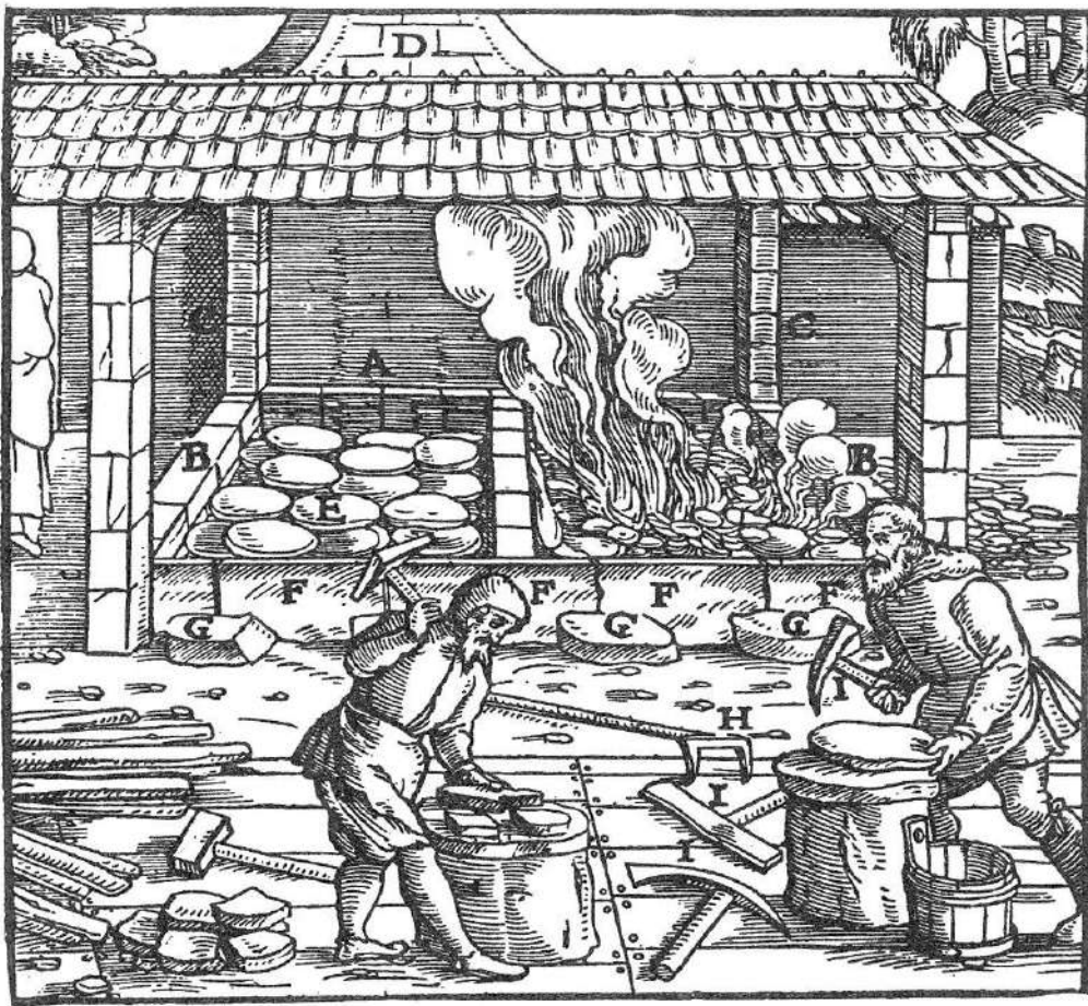
Задня стіна A . Бокові стіни B . Стовпи C . Димохід D . Вставлені в піч зливки міді E . Залізні листи F . Булижники G . Двозубі граблі H . Молот I .
