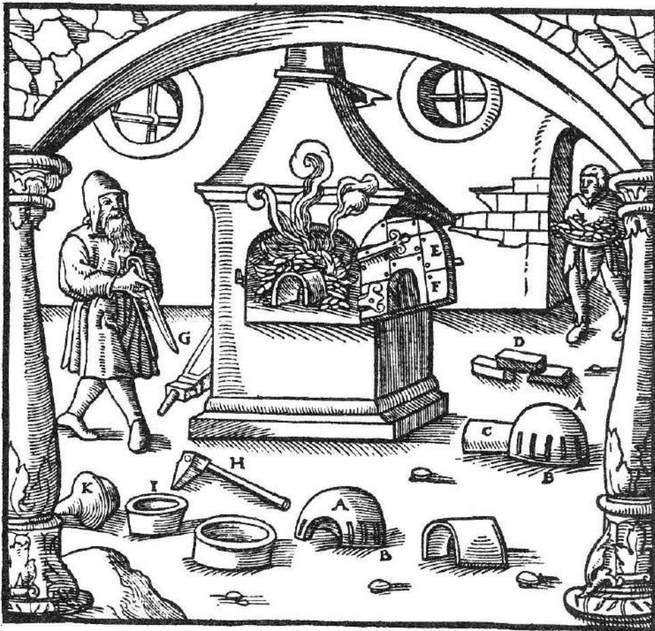
Муфель A . Віконце в ньому B . Мостик C . Цеглини D . Залізні двері E . Віконці в них F . Міхи G . Сокира (молоток- долото) H . Залізне кільце ( I ), яке іноді застосовують замість чаші. Товкач ( K ) для трамбування золи в кільці.
