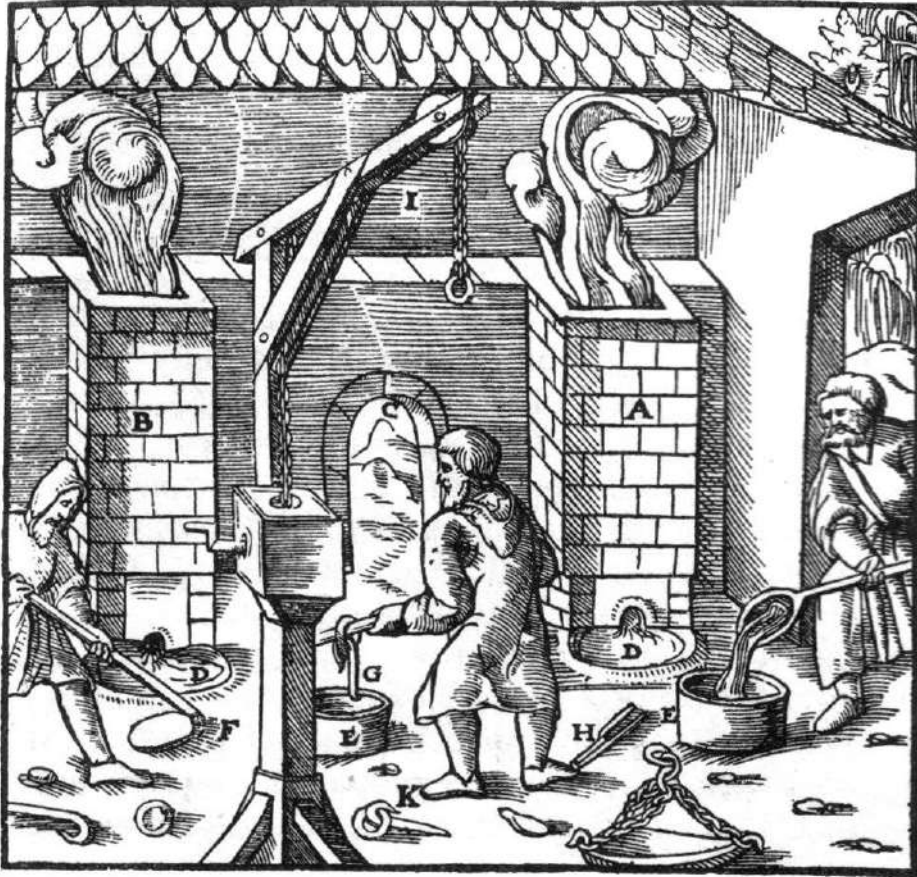
Піч (A), в якій переплавляються шлаки. Піч (B), в якій мідь легується зі свинцем. Двері C. Вкопаний у землю шпуртигель D. Мідна виливниця E. Лопата F. Гак G. Розщеплена дерев'янка H. Стріла коловорота I, гак його ланцюга K.
