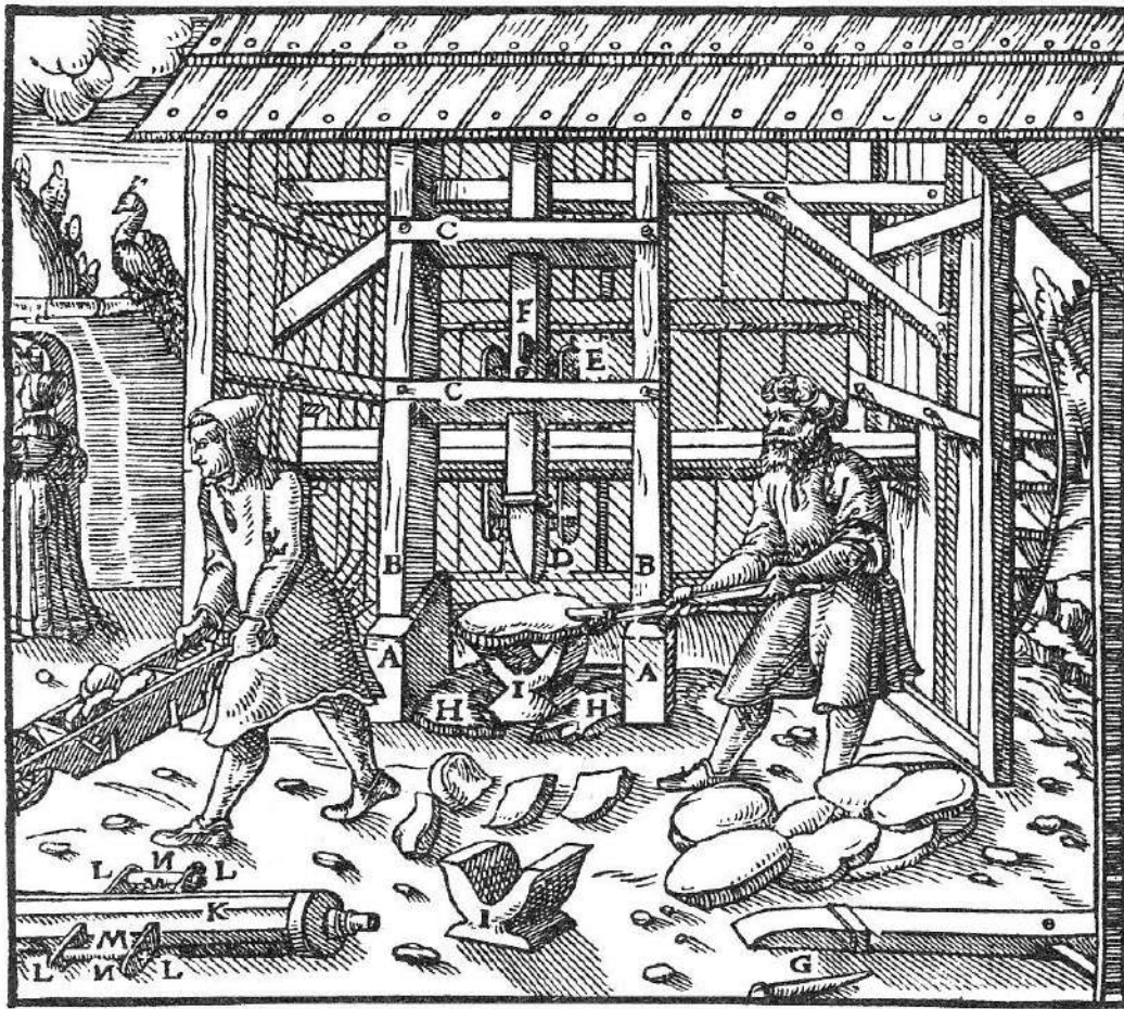
Колода A . Стовпи B . Ригелі C . Наконечник товкача D , його кулак E , отвір в товкачі F , залізний клин G . Свинцеві зливки H . Мідне сидло I . Вал K , його зуби L , мідна втулка M , залізний валик N .
