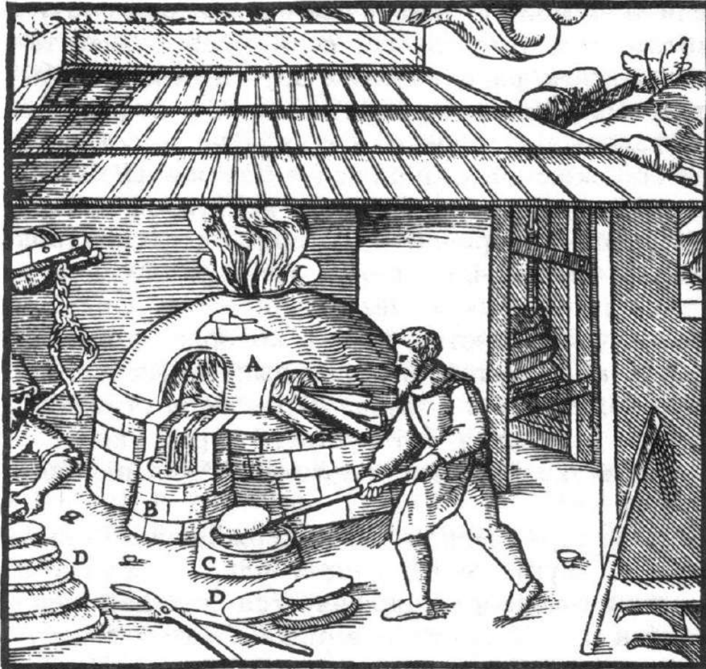
Плавильна піч A . Верхнє випускне гніздо B . Нижнє випускне гніздо C . Зливки D .
