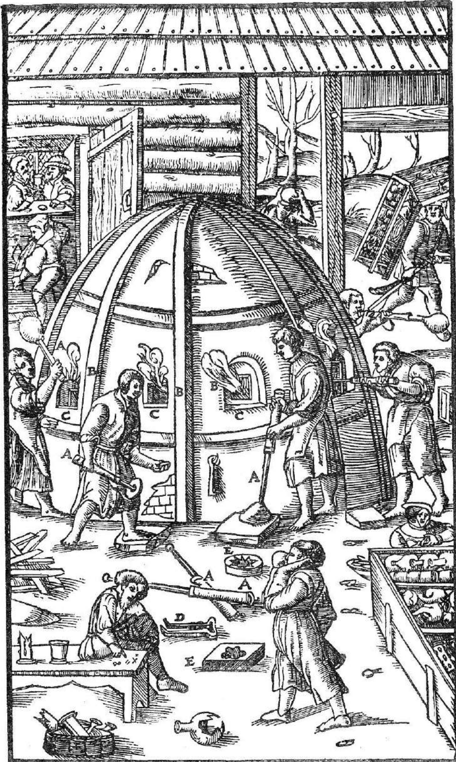
Трубки А. Віконця В. Мармур С. Щіпки D. Форми для виробів E.
