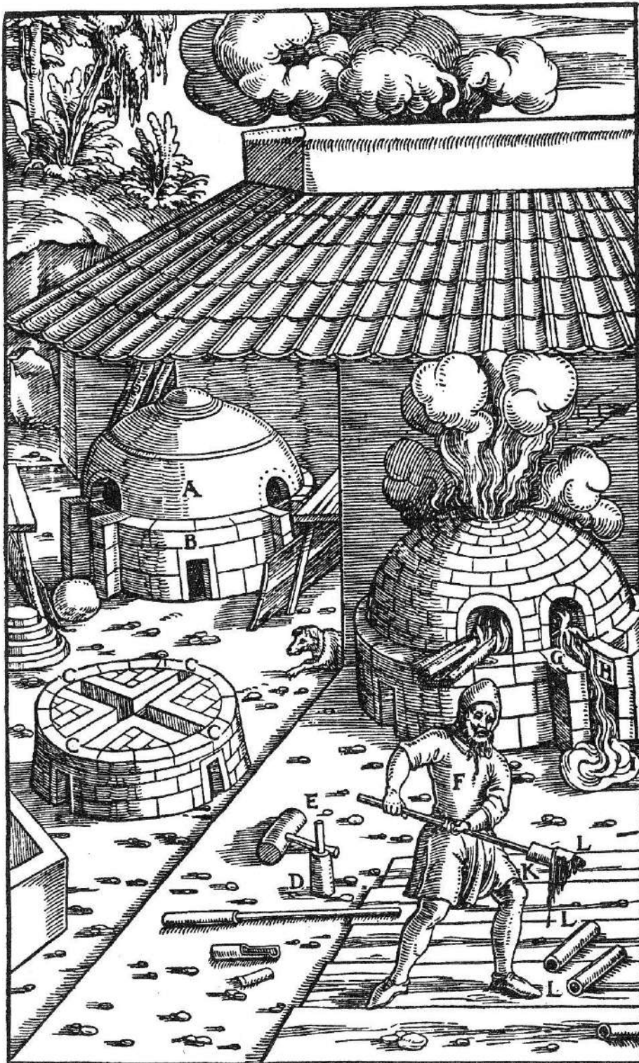
Склепіння печі A . Її основа B . Канали C . Трамбівка D . Молоток E . Майстер ( F ), що виготовляє труби з глету за римським способом. Канавка G . Глет H . Нижній горн I . Вертел K . Труби L .
