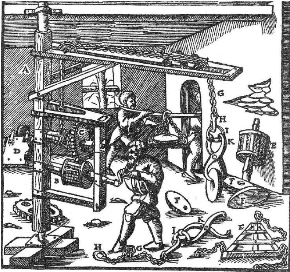
Коловорот A . Цівкове колесо B . Зубчасте колесо C . Рухомий возик і його ролики D . Трикутні дощаті ноші E . Зливки F . Ланцюг коловорота G , її гак H . Кільце I . Кліщі K .
