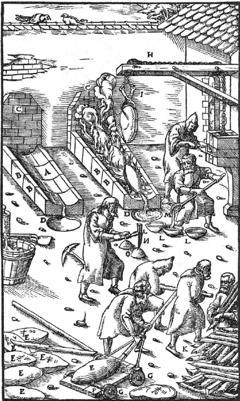
Горн A . Кам'яні плити, вкопані в землю B . Стіна ( C ), яка захищає від дії вогню четверту повздожню стіну. Випускний тигель D . Свинцеві брили E . Возик ( F ), його колеса ( G ). Колорот H . Кліщі I . Дрова K . Виливниця L . Ківш M . Клевець N . Свинцеві зливки O .
