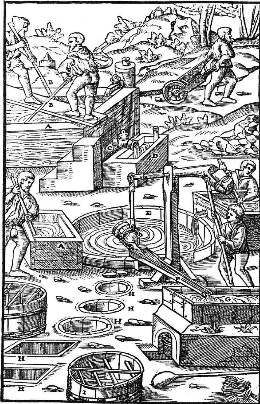
Великі чани A . Жердини B . Кран C . Корито D . Круглий чан E . Жолоб F . Свинцевий черен G . Вкопані в землю посудини H . Діжка з поперечинами I .
