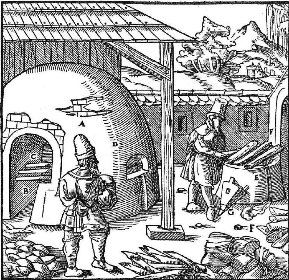
Піч, схожа на хлібопекарську A . Прохід B . Колосники C . Отвір для вилучення глету D . Горн без ковпака E . Товсті поліна F . Міхи G .
