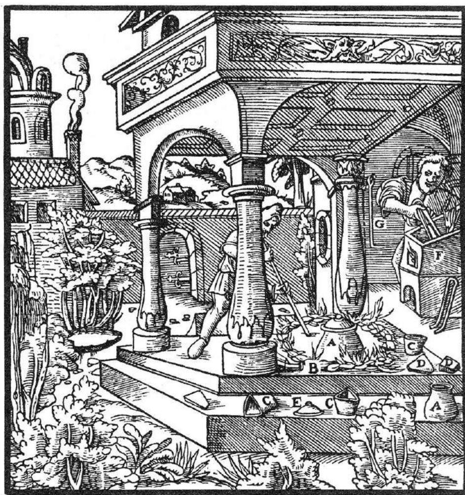
Горщик A . Купа вугілля навколо горщика B . Тигель C . Його кришка D . Кришка до горщика E . Піч F . Кочерга G .
