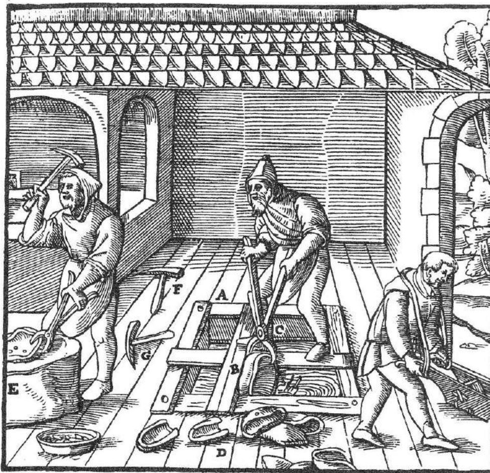
Чан A . Дошка B . Кліщі C . Відпалені зливки ( D ), вилучені з чану. Колода E . Округлений молот F . Кльовці G .
