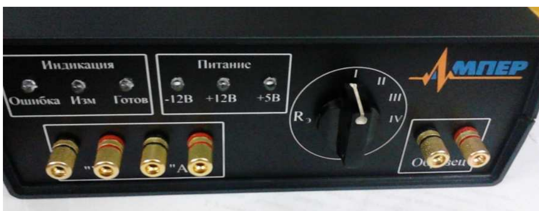
Рис. 3. Общий вид фронтальной панели измерительного комплекса «Ампер»
