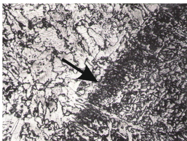
Рис. 1 – Мікроструктура ділянки сплавлення ЗТВ зварного з'єднання зі сталі 15X1M1Ф. \times 500 . Перлітний прошарок відмічений стрілкою
