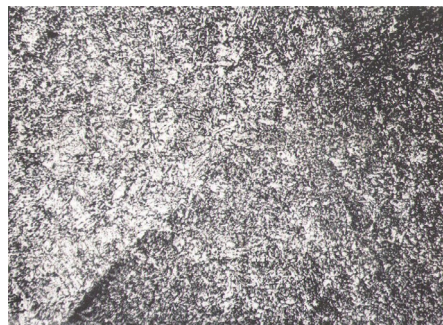
Рис. 2 – Ділянка сплавлення зварного з'єднання зі сталі 15X1M1Ф. \times 100
