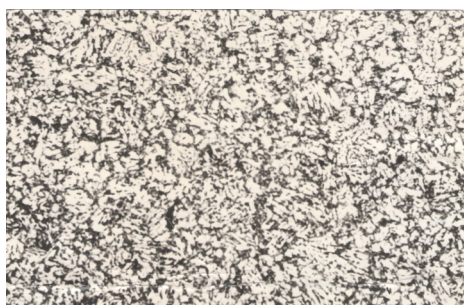
Рис. 3 – Мікроструктура ділянки неповної перекристалізації ЗТВ зварного з'єднання зі сталі 12X1M1Ф. Ресурс 276 тис. год. \times 100
