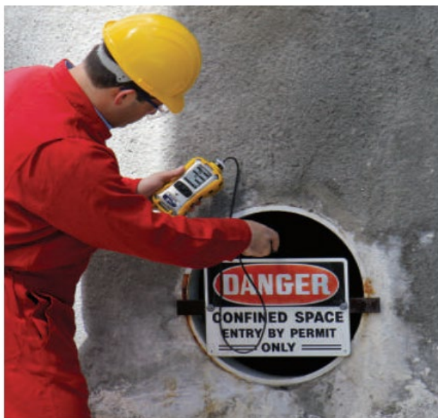
Рисунок 8.8 – Приклад тестування в обмеженому просторі газосигналізатором MultiRAE з вбудованим насосом
