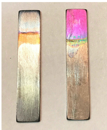
Рисунок 7.5 – Зовнішній вигляд оксидованого титану з плівкою різної товщини
