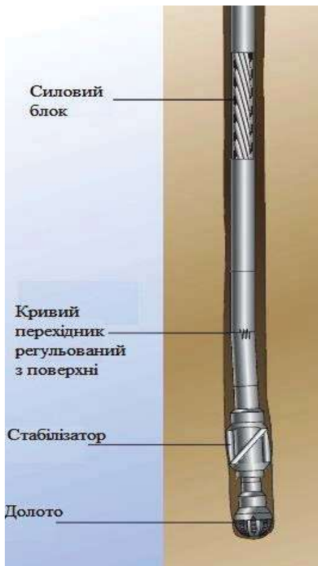
Рисунок 3.7 – Гвинтовий вибійний двигун
