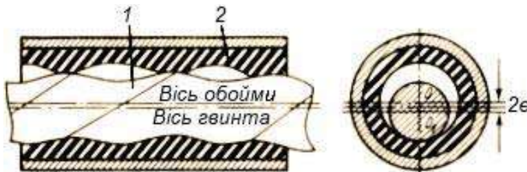
Рис . 6.10. Схема елемента гвинт – обойма гвинтового насоса: 1 – металевий гвинт; 2 – еластична обойма
