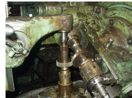
Рисунок 3 – Изготовление квазиглобoidного колеса
