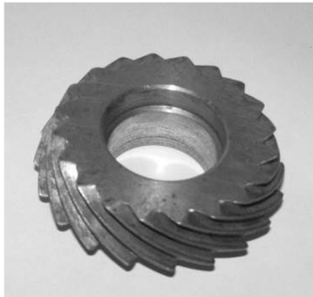
Рисунок 4 – Квазиглобоидное колесо с z_1=20 ; m=1,5 ; \beta=60^\circ
