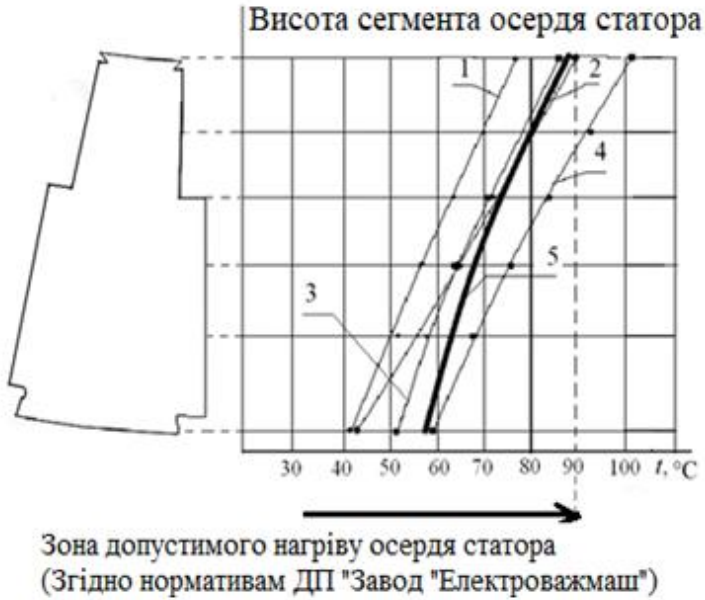
Рисунок 6 – Зміна температури в осерді ТГ по висоті сегмента при різній потужності, при різних типах охолодного середовища
