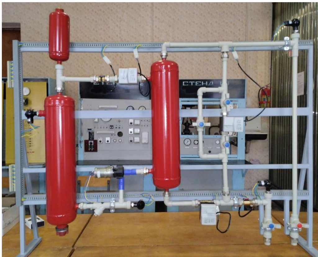
Рис. 1 – Технологічна частина лабораторного комплексу «Теплопункт»
