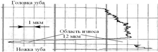
Рисунок 2 – Эвольвентограмма профиля зубчатого колеса z=49, \alpha=25^\circ, F_{нН}=22909Н после испытаний
