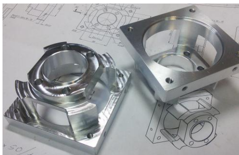
Рис. 4 – Готовое изделие «нежесткий фланец» – результат применения передовых CAD/CAM/CAE-систем
