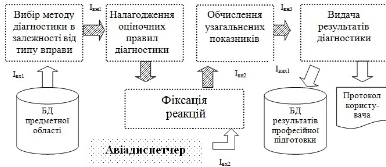
Рис. 3 – Функціональна схема автоматизованої системи управління допуском авіадиспетчерів до самостійної роботи з УПР
