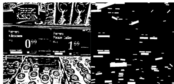
Рис. 4. Результати застосування морфології (зліва) та заливки контурів після неї (справа)
