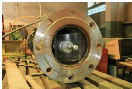
Рисунок 7 – Фотография реактора для получения импульсного коронного разряда
