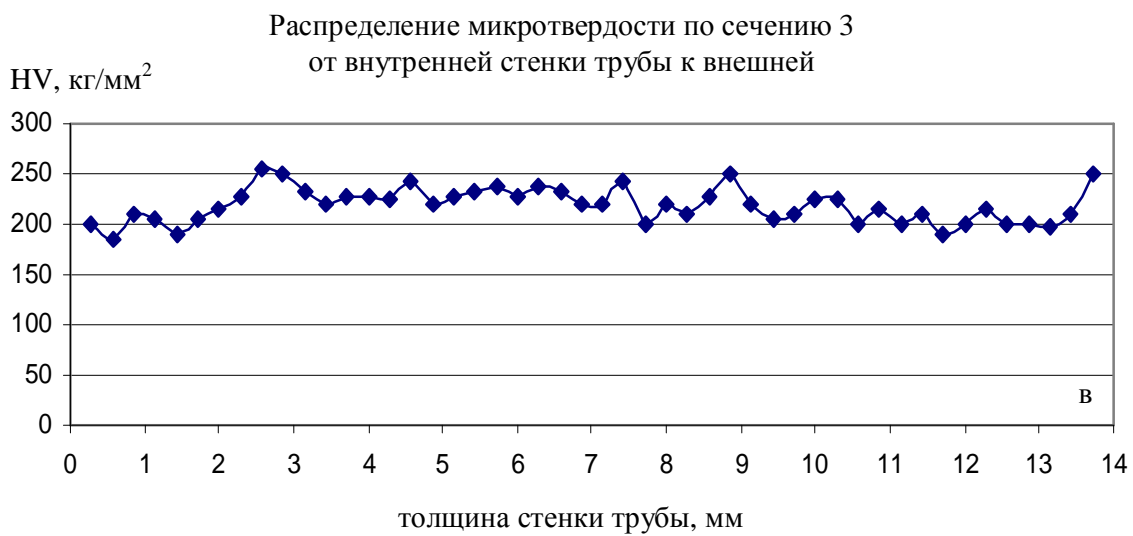
Рис. 4. Изменения микротвёрдости по сечению трубы
