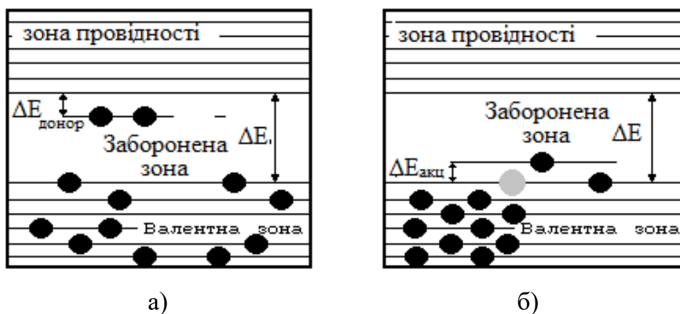
Рис. 1.1 - Енергетична діаграма напівпровідника з донорними (а) та акцепторними (б) домішками
