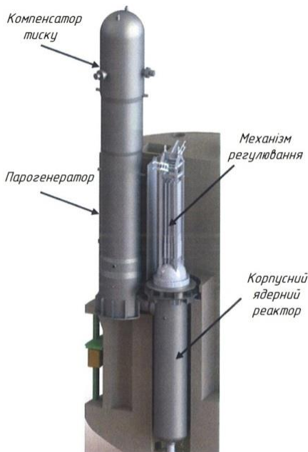
Рис. 1 – Основні системи реактора SMR-160
