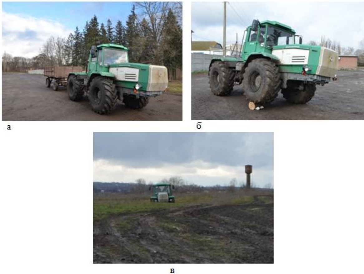
Рисунок 3 – Проведення експериментальних досліджень на шарнірно-сочлененому тракторі ХТА-200 “Слобожанець” і тракторному поїзді: а – висота нерівностей 0,2 м; б – переїзд єдиного перешкоди; в – висота нерівностей 0,3 м
