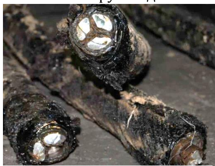
Рис. 3 – Кабель з паперовою ізоляцією в аварійному стані
